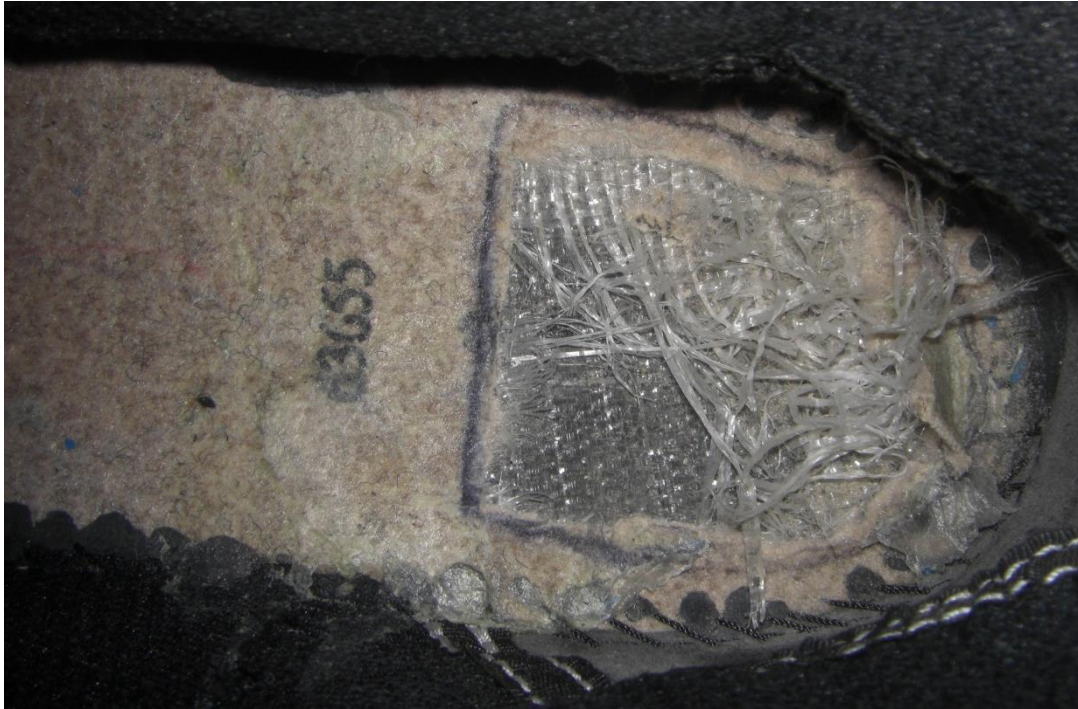
BMS 5 Viser "glassfiber" i hælområdet i skoen, bildet tatt ovenfra.
